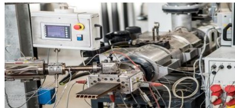
Profilextrusion mit Co-Extrusion von Natur- und Reststoffen
