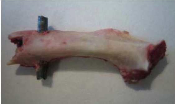
Bild 3: Knochen mit Magnesium-Implantatstift vor Ausstoßversuch (aus Bakkalaureatsarbeit Gerald Holzlechner TU Wien)
