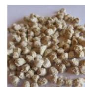
Granulate und extrudiertes Formrohr aus dem neuen Hanfstroh-Verbundwerkstoff
