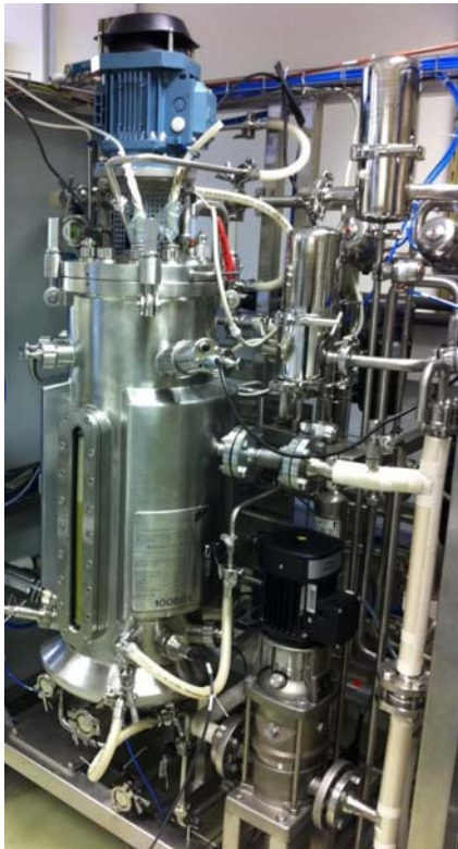
Bioreaktor zur Prozessoptimierung und Herstellung von Mustern rekombinanter Proteine Foto: BOKU-DBT
