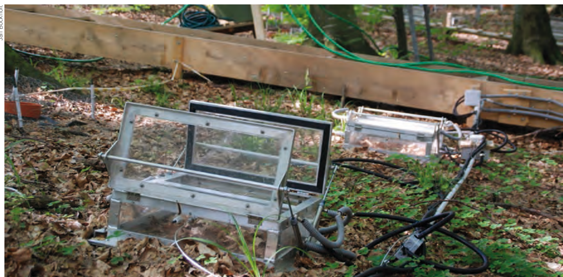
Messung von Treibhausgasen im BOKU-Lehrforst Rosalia
