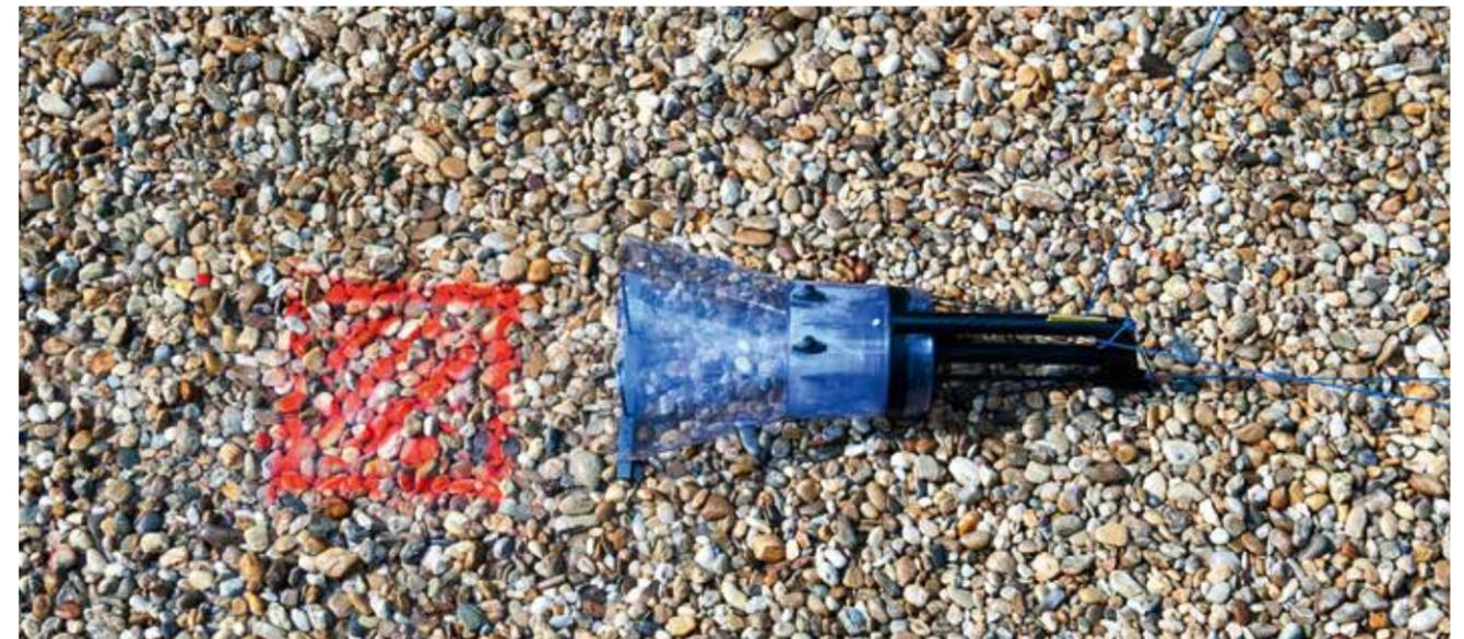
In einem Abschnitt ist Donauschotter eingebracht, um zu beobachten, wie die einzelnen Steine transportiert werden: Mit in den Kanal eingebauten Messschleifen und Codes in den Steinen wird genau registriert, wann und wie sich die Steine bewegen.
