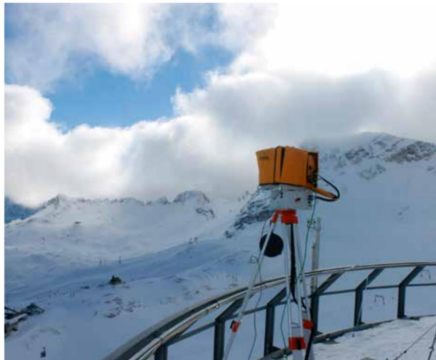
Schneehöhenmessung am Zugspitzplatt mit LIDAR-System
