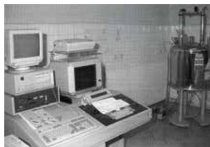
Das 300-MHz-Kernresonanzspektrometer des Instituts für Chemie, 1995
