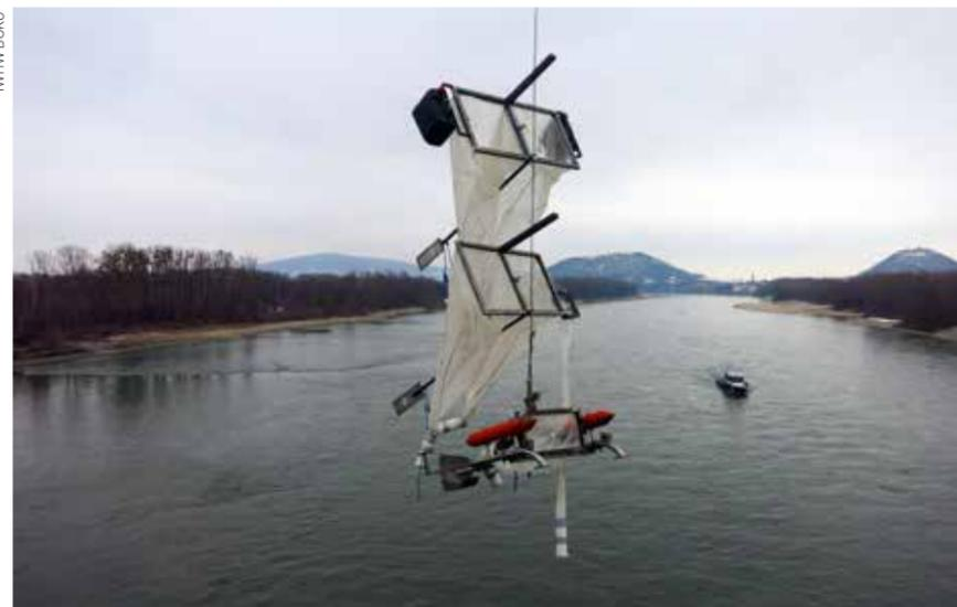
Messgerät zur Beprobung des Plastiktransportes an großen Fließgewässern
