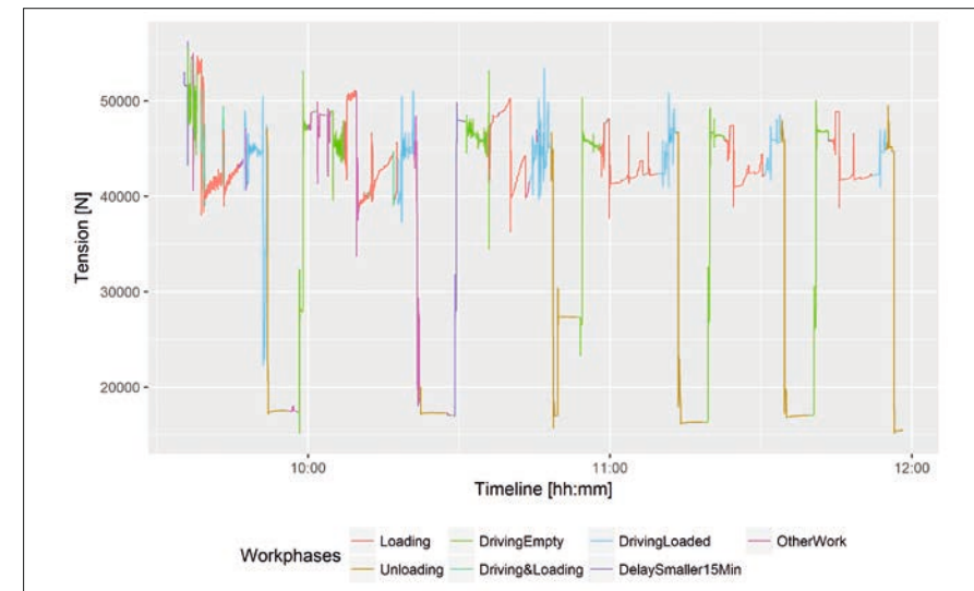
Abbildung 2: Typischer Seilspannungsverlauf bei der Arbeit mit dem Forwarder
