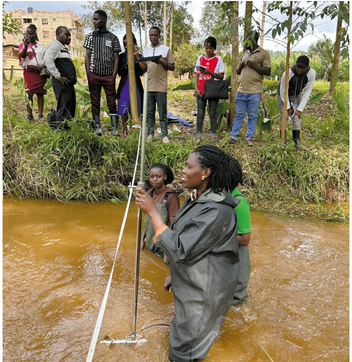
Fließgeschwindigkeitsmessung für die Durchflussbestimmung (Flügelmessung)
