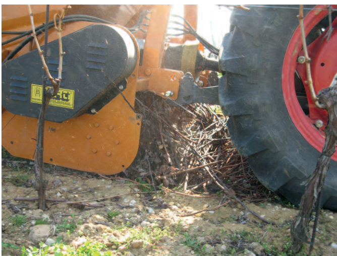
Aufnehmen und Häckseln des Rebholzes in ca. 4 cm große Stücke
