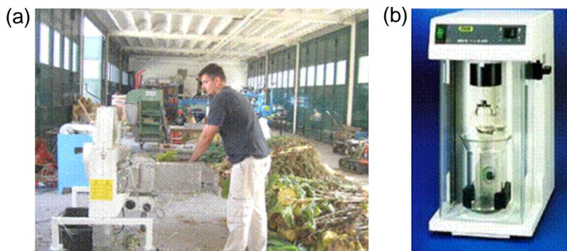
Abbildung 1: Grob- (a) und Feinzerkleinerung (b) der Energiepflanzen.
