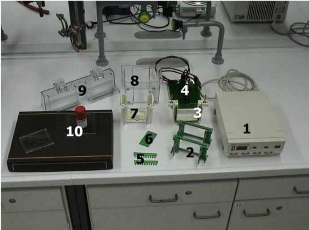
Figure 1: Die Teile der Elektrophoreseapparatur
