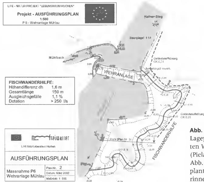
**Abb. 10.42** Lageplan der sogenannten Wehranlage Mühlau (Pielach Mittellauf; P9 in Abb. 10.40) mit neu geplante Umgehungsgerinne (Errichtung 2002).
