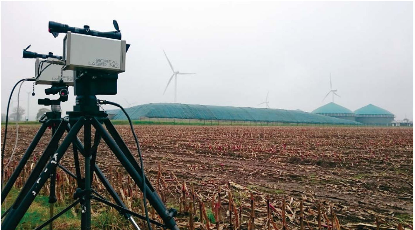
Einsatz der open-path Lasermessgeräte zur Quantifizierung der Methanemissionen aus Biogasanlagen
