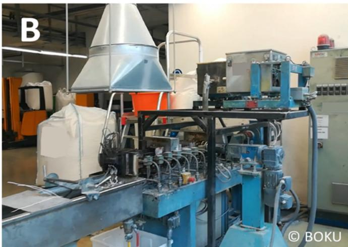
(A) Einrühren von speziellen Markern in Kunststoffpellets. (B) Extrusion zur Weiterverarbeitung zu technischem Kunststoff („Compoundierung“).
