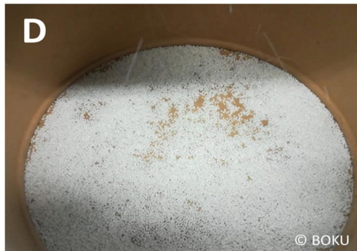
**(C) Abkühlen und Abschneiden der Pellets. (D) Fertige Pellets Polyoxymethylen und den Markern (Additiven), die die Detektion bzw. Sortierung beim Kunststoffrecycling zukünftig erleichtern sollen.**
