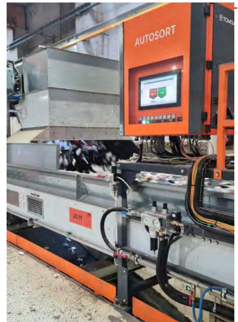
*Eines der 39 NIR Aggregate in der TriPlast.*
