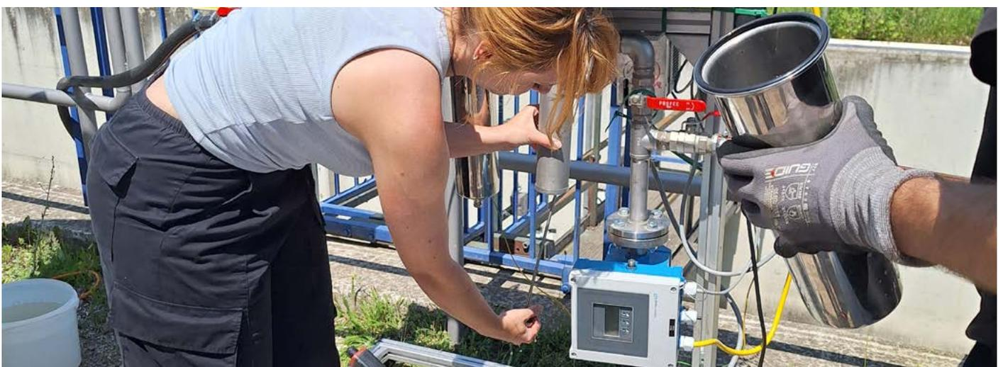
*Probenahme mittels Pumpe.*
