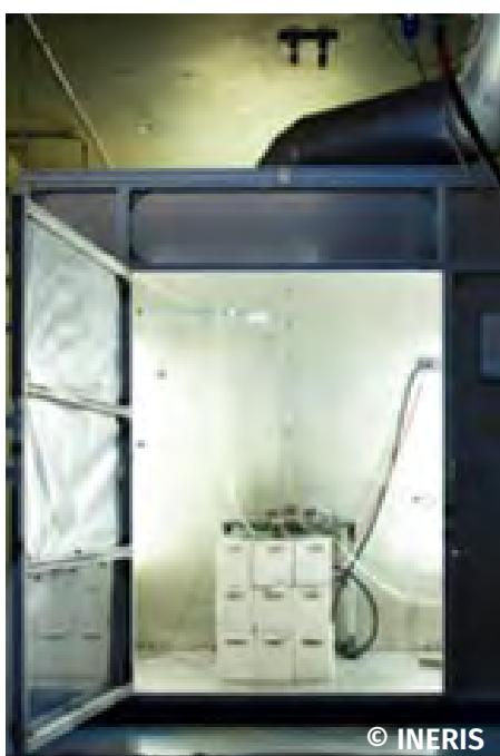
Testzentrum von INERIS für Untersuchungen von LIBs bei unsachgemäßer Nutzung.
