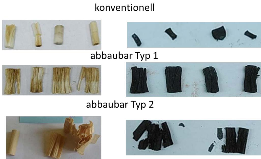
Abbildung 6: Zigarettenfilter vor (links) und nach (rechts) einer Behandlung für 3 Stunden bei 300 °C im Muffelofen unter Luftzufuhr
