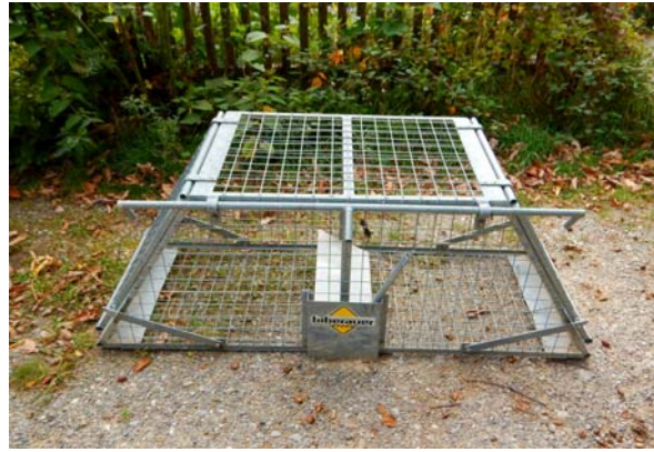
Abb.8.3. Fängig gestellte Kastenfalle mit rechts und links geöffneten Flügeltüren (li). Die Falltüren liegen auf einer Haltestange auf, die sich ausdreht, wenn durch das Kippen der am Boden mittig liegenden Trittplatte die senkrechte Haltestange ausgelenkt wird, die beiderseits beweglich angebrachten schrägen Flacheisen mit der Einkerbung sichern die Türen gegen das Öffnen, ein Tritt auf die Platte löst den Mechanismus aus und die beiden Flügeltüren fallen zu. Auf dem rechten Bild ist die Form der Kastenfalle zu sehen, beide Flügeltüren der Falle sind hier geschlossen. ©G.Hölzler
