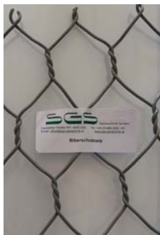
Abb.6.7. Beispiel eines Drahtgitters, das als Schutzmaßnahme gegen die Grabetätigkeiten des Bibers in die Uferböschungen eingelegt werden kann. ©SGS Geotechnik GmbH
