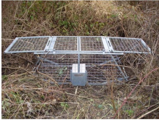
Abb.8.3. Fängig gestellte Kastenfalle mit rechts und links geöffneten Flügeltüren (li). Die Falltüren liegen auf einer Haltestange auf, die sich ausdreht, wenn durch das Kippen der am Boden mittig liegenden Trittplatte die senkrechte Haltestange ausgelenkt wird, die beiderseits beweglich angebrachten schrägen Flacheisen mit der Einkerbung sichern die Türen gegen das Öffnen, ein Tritt auf die Platte löst den Mechanismus aus und die beiden Flügeltüren fallen zu. Auf dem rechten Bild ist die Form der Kastenfalle zu sehen, beide Flügeltüren der Falle sind hier geschlossen. ©G.Hölzler
