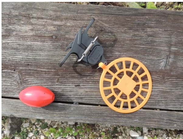
Abb. 56: In Frankreich verwendete Gegenstände zur Visualisierung von Liftseilen. Links: rote Markierungsboje zur Sichtbarmachung von Schleppliftseilen; rechts: Lösung zur Sichtbarmachung von Seilen von Sesselliften und Gondelbahnen (zur Verfügung gestellt von Virginie Dos Santos, Chargee de Developpement - Alpes, Observatoire des Galliformes de Montagne.)
