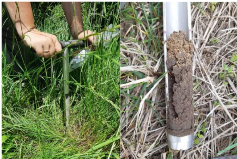
Abbildung 5: Zur Erhebung der mikrobiellen Biomasse und Nekromasse werden mehrere Bodenzylinder je Beprobungsfläche mithilfe eines Bodenbohrers entnommen, welche als Mischprobe im Labor weiterverarbeitet werden.
