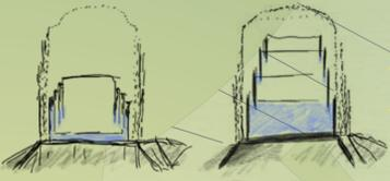
Als prägende Elemente Simmerings stehen die ikonischen Gasometer emblematisch als Grundmotiv für diesen Entwurf. Da scheint es naheliegend, sich die Konstruktion und Bauweise näher anzusehen. Die Skizzen verdeutlichen die Funktionsweise der Teleskopbehälter (links: ungefüllter Zustand, rechts: gefüllt).
