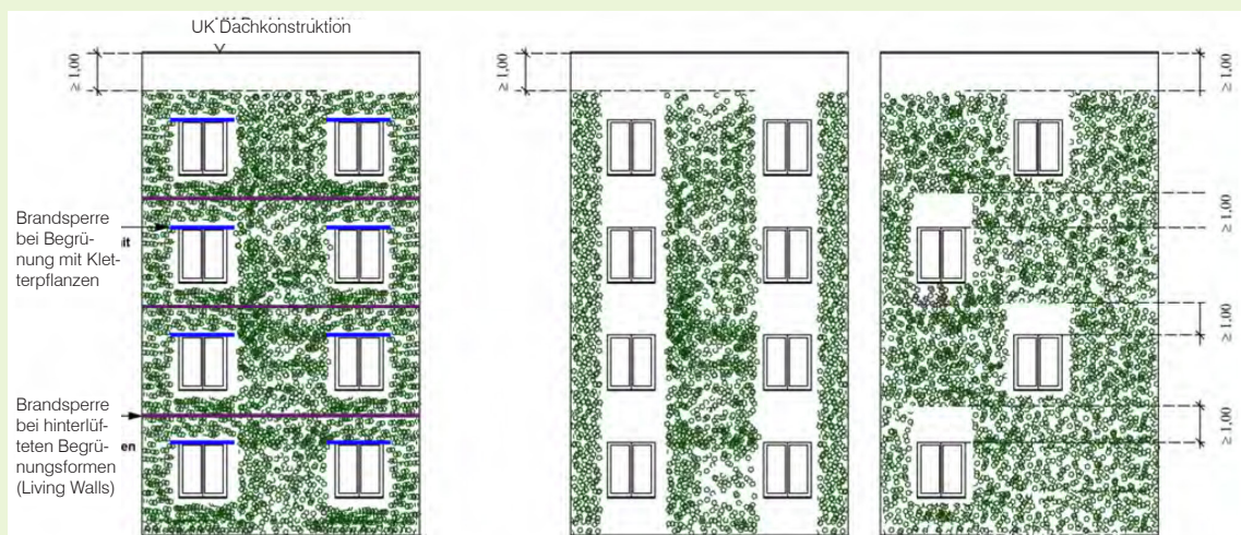
Nachweisfreie Möglichkeiten zur Montage von Fassadenbegrünungen (MA 22)
