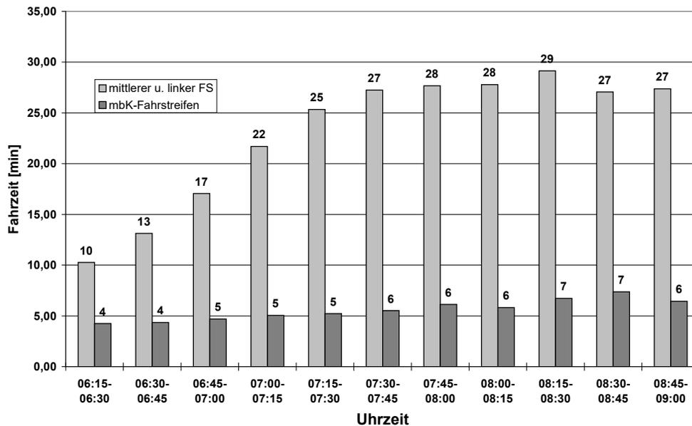
Abb. 2.6-1: Vergleich der mittleren Fahrzeiten der mbK-Fahrstreifen-Benutzer und der übrigen Kfz je Viertelstunde in Fahrtrichtung Linz auf der B127 von 6:15 bis 9:00 Uhr (Querschnitt X-Dorf, Montag 10.05.1999)
