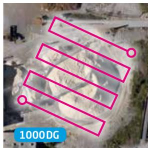
Wie Sie rechts sehen, reduziert sich dank der DG (Direct Georeferencing)-Lösung der Zeitaufwand für den Überflug und dadurch auch die Anzahl der später zu bearbeitenden Fotos.
