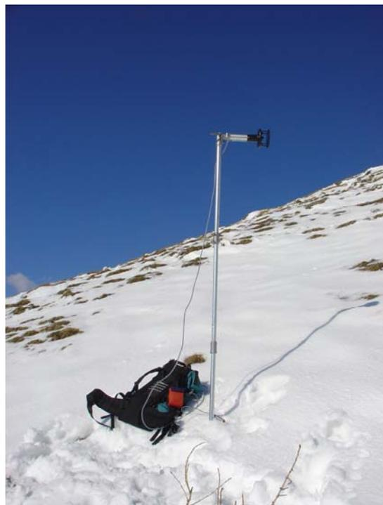
Abbildung 25: Messen des Windprofiles in 2 m Höhe auf der Freifläche (Kopf um 90° geneigt)
