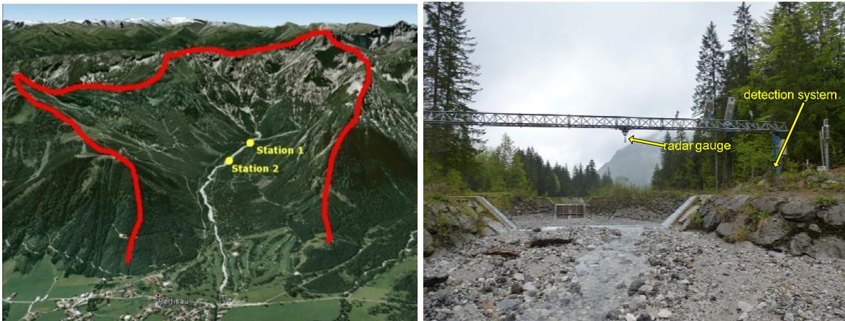
Abb. 2.4 Übersicht des Einzugsgebietes und der Monitoringstationen in Dristenau (Quelle: Google Maps) und der Position des Detektionssystems
