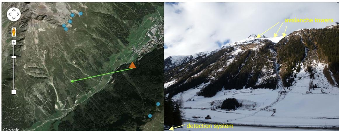
Abb. 2.6 Übersicht des Einzugsgebietes und der Monitoringstation in Ischgl (Quelle: IDA) und der Position des Detektionssystems (Dreieck) (Lawinen-Sprengmasten: blaue Punkte)
