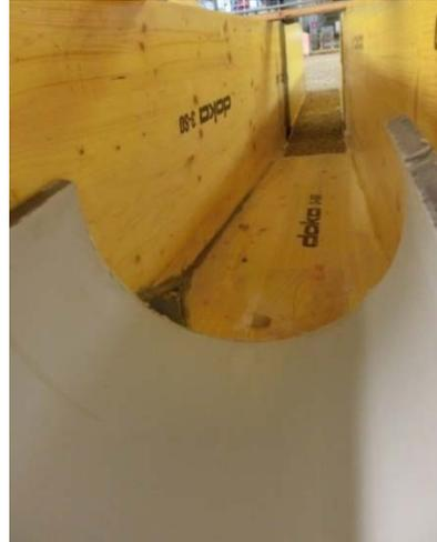
Abbildung 10: linkes Bild: Durchmischungszone; im Hintergrund Thomson Wehr mit seitlicher Sedimentzugabe; rechtes Bild: Der Übergang von der Durchmischungszone zum Einlaufbauwerk
