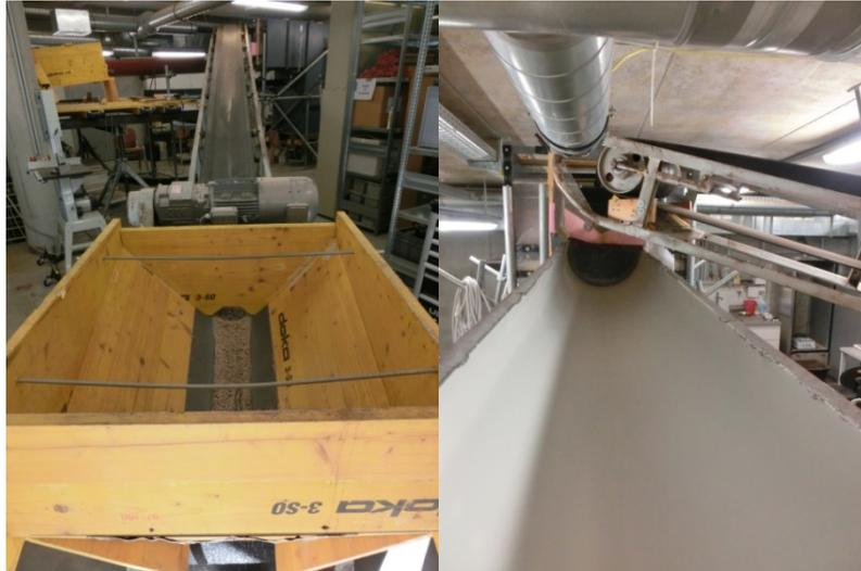
Abbildung 27: linkes Bild: Vorratsbehälter für die Sedimentzugabe mit Förderband; rechtes Bild: Durchmischungsgerinne mit Förderband zur Beschickung mit Geschiebe, im Hintergrund Thomson Wehr als Einlaufbauwerk für das Wasser
