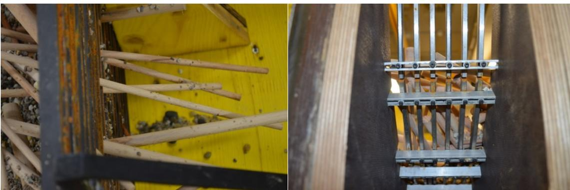
Abbildung 34: linkes Bild: Balkensperre mit massiver Verklausung; rechtes Bild: Rückseite der Rechensperre; die Hölzer lagern sich direkt an den vertikalen Stäben an und treten nicht hindurch.
