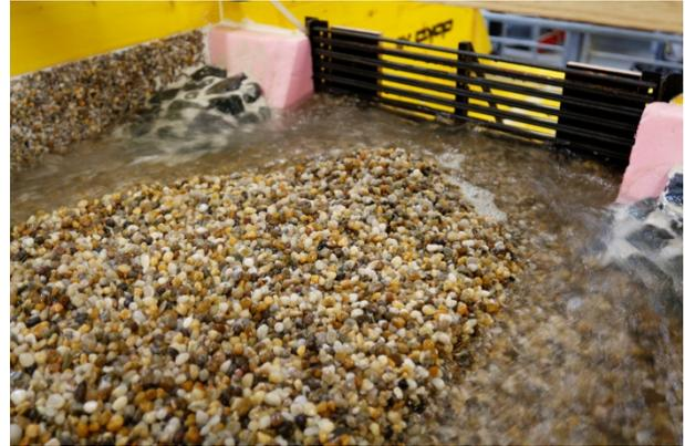
Abbildung 17: Fotos der Balken und Rechensperre.
