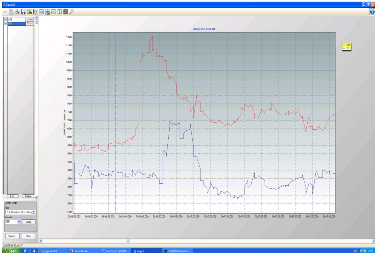
Abbildung 6: Verlauf der Ultraschallpegelmessungen des Ereignisses (Lattenbach 26.08.12) (Quelle: Institut für Alpine Naturgefahren 2012)
