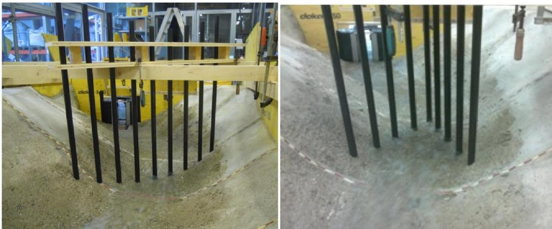
Abbildung 16: Wildholzrechenkonstruktion (links gerader Rechen; rechts V-förmiger Rechen)
