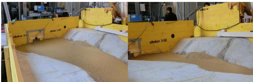
Abbildung 23: Kurvenüberhöhung (Bsp. MV\_008)
