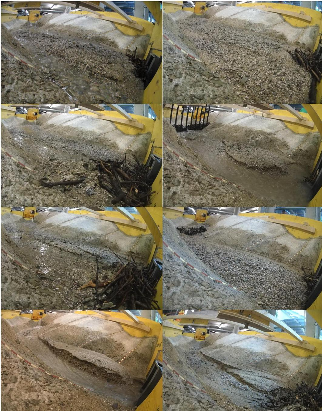
Abbildung 24: Ablagerungsverhalten nach Versuchsbeendigung von GV\_001 bis GV\_008 (v. oben links nach unten rechts)
