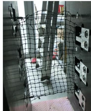
Abbildung 19: Messeinrichtung Netzsperr Ankerkraft mit Messtechnik HBM (Konstruktion IAN)
