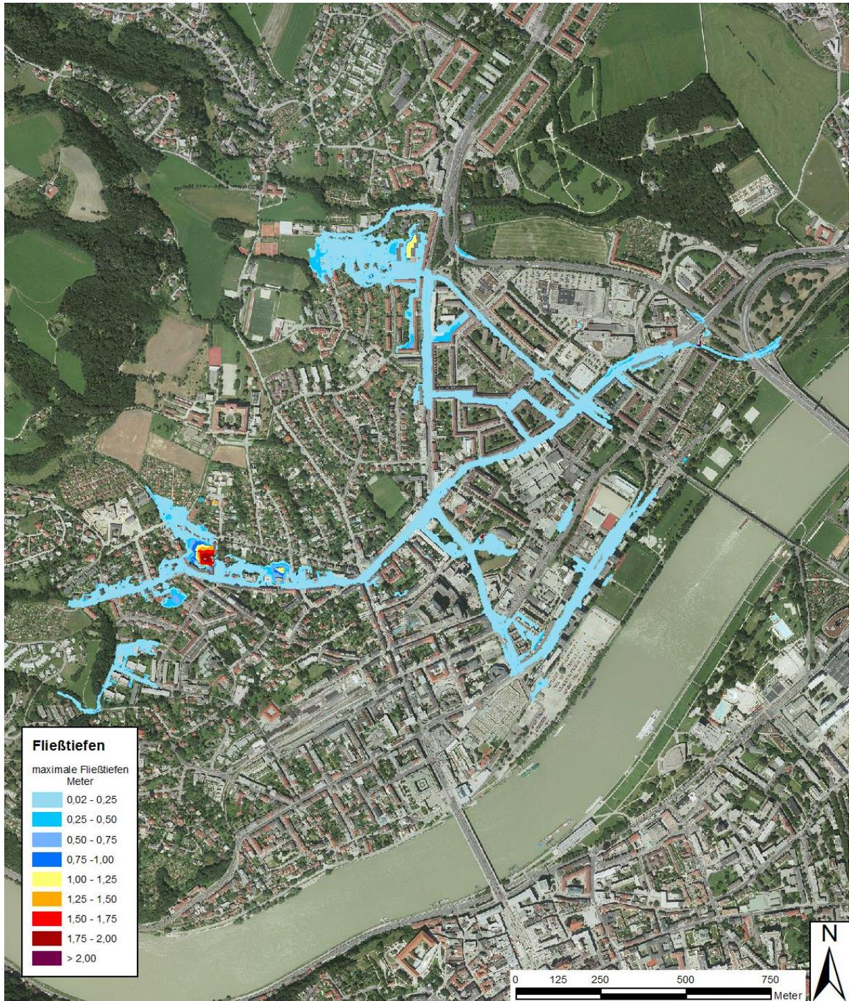
Abbildung 69: maximale Fließtiefen Netz D Bemessungsfall 2
