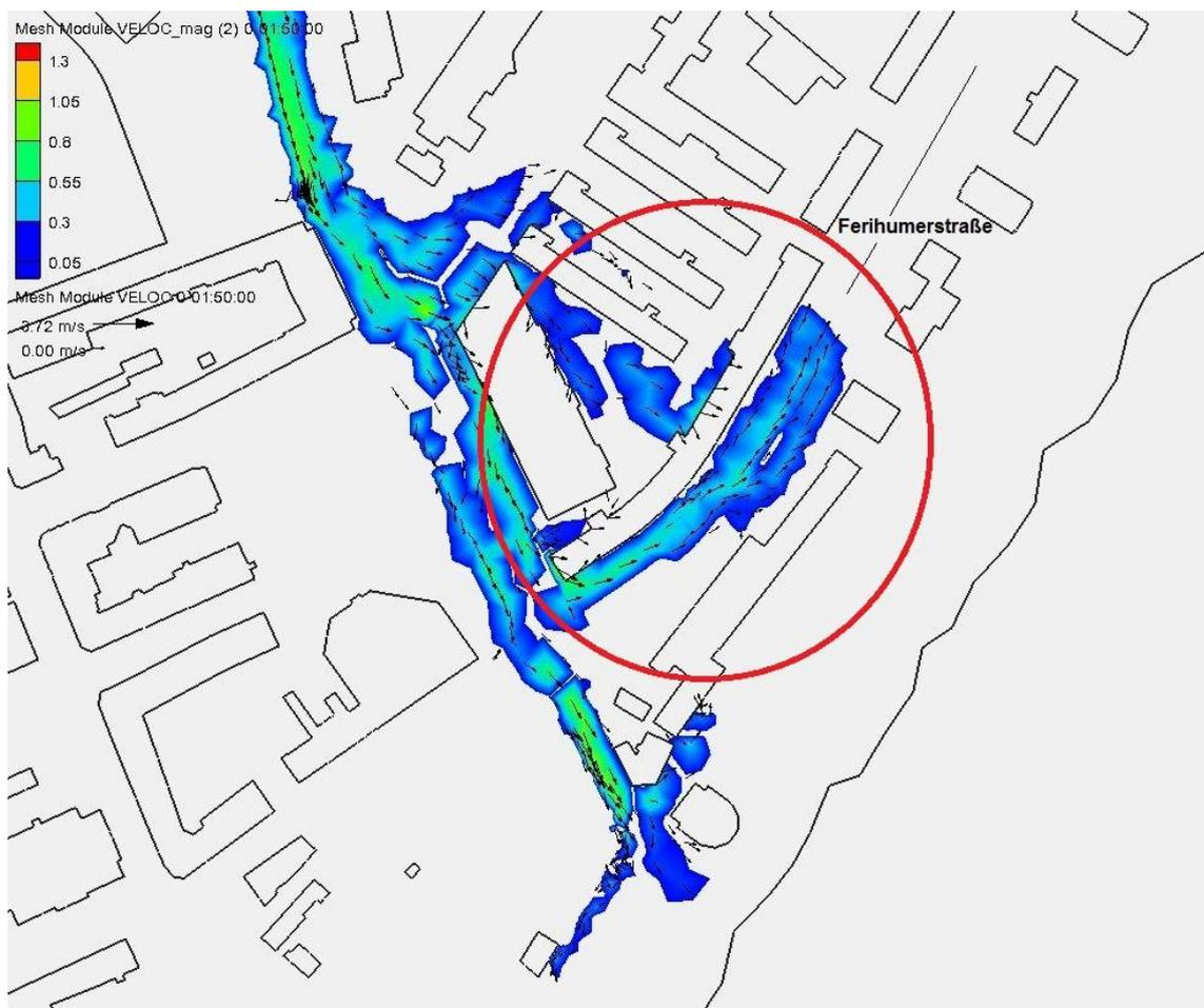
Abbildung 54: Ausschnitt der Fließgeschwindigkeiten zu Zeitschritt 1:50 h im Nahbereich der Gebietsbauleitung – Simulationsnetz Pflasterbach Bahngraben
