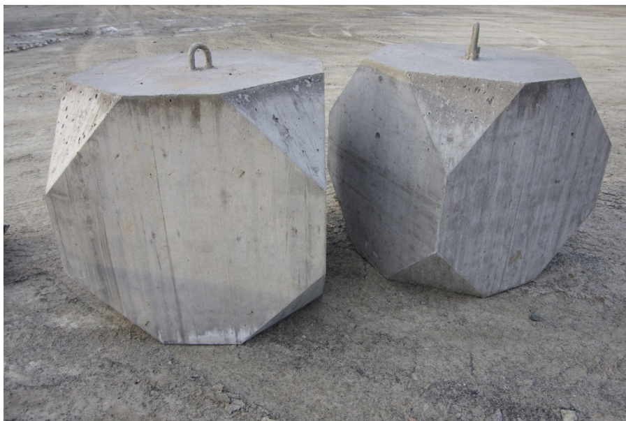
Abbildung 8: Betonversuchskörper mit einem Gewicht von je 2300 kg
