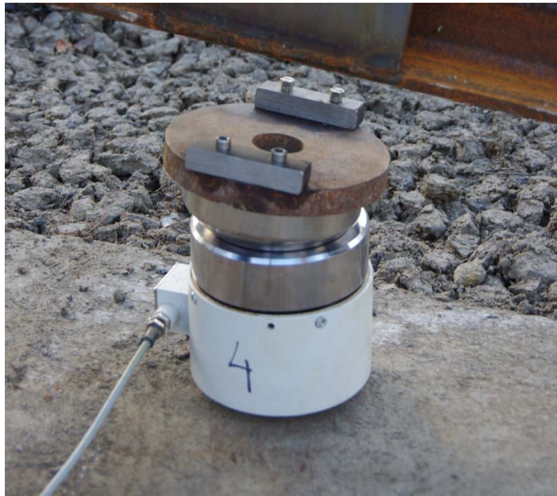
Abbildung 7: Lagerung des Stahlträgers auf einem Kraftaufnehmer C6A1 (2MN) zur Messung der Auflagerkräfte.
