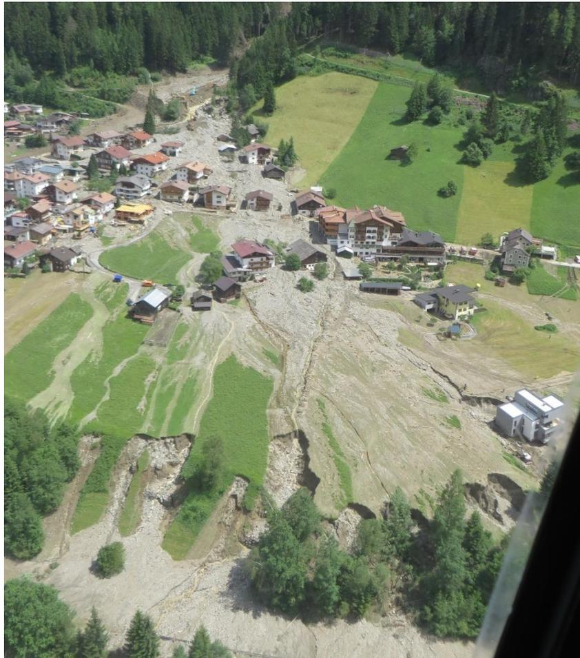
Abbildung 55: Überblick der Ablagerungen in den Ortsteilen Griß und See-Dorf und den Erosionen oberhalb der B 188 Paznaunstraße (Quelle: WLV)
