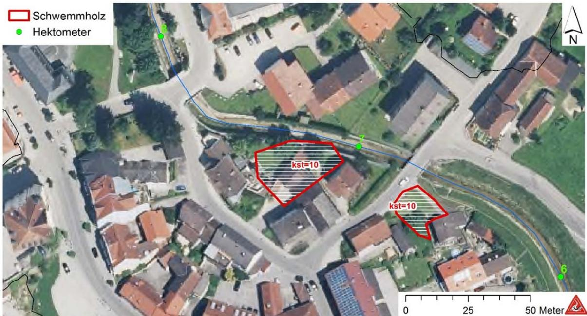
Abbildung 68: Netz 3a, Berücksichtigung von Schwemmholz zwischen hm 6.7 bis 7.5
