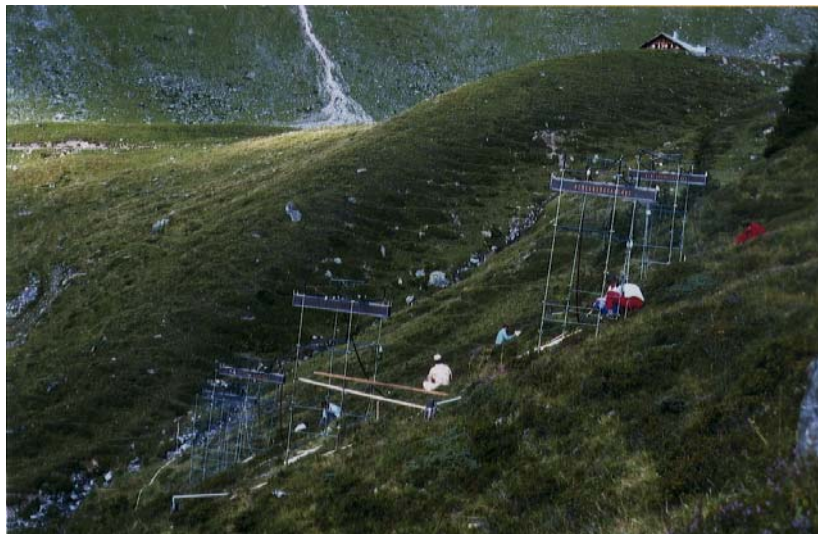
Abbildung 21: Einsatz der RSA im Steilgelände (Löhnersbach 1993)
