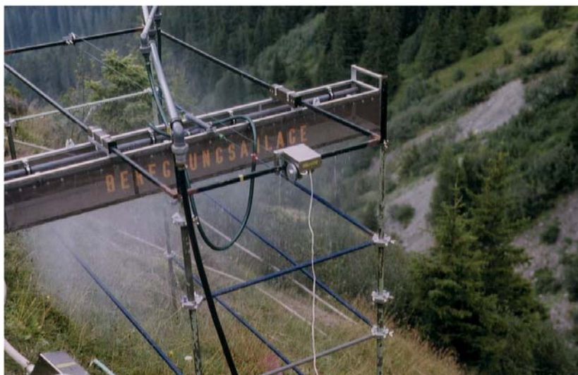
Abbildung 22: Stahlrohrrahmen und Schlitten mit Antriebsmotor
