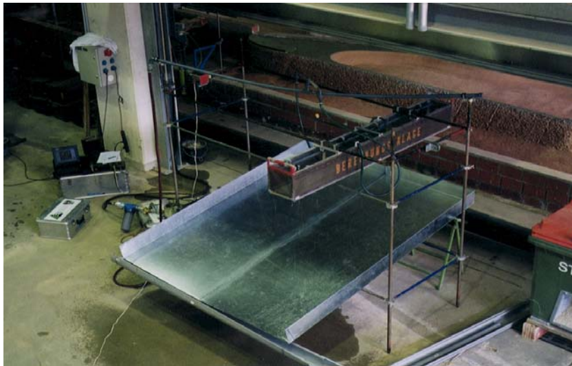
Abbildung 26: Eichung der Durchflußregler im Labor
