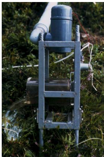
Abbildung 25: Kippelement beim Entleerungsvorgang
