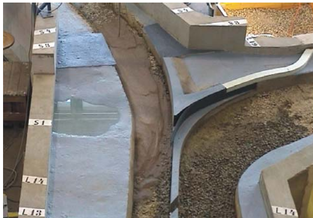
Variante 2: Abgesenkte Trennwand
