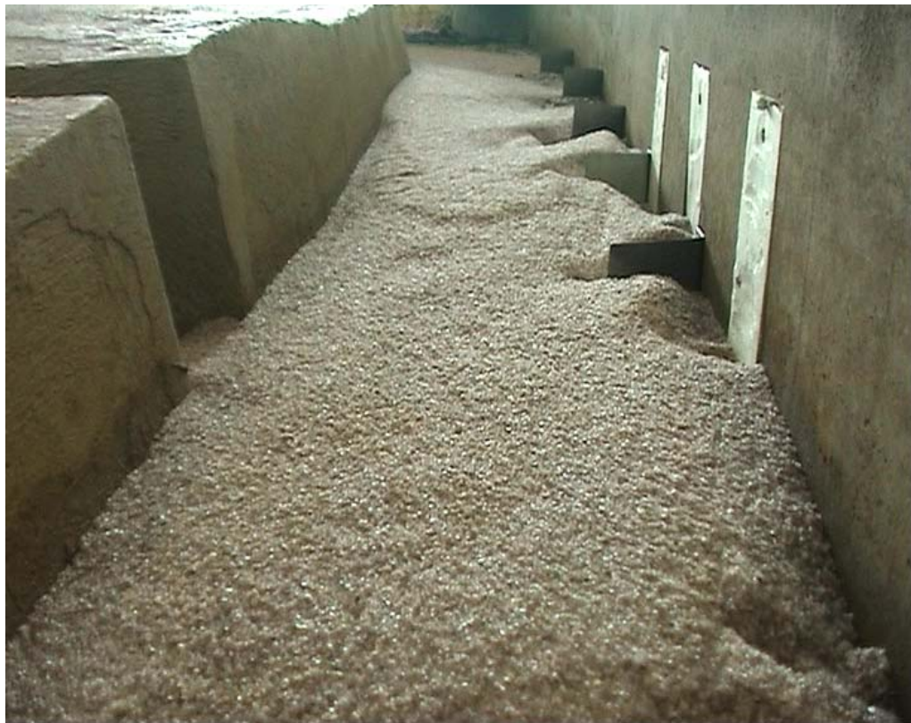
Abb. 51: Ablagerungskörper bei fünf eingebauten Buhnen und dem Versuch V.1.G.1.3
