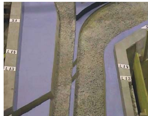
Variante abgesenkte Trennwand, Mündungsbereich - Blick nach flussauf
