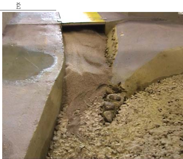
Abb. 36: Ablagerung beim Versuch V.0.G.3.3; Blick nach flussauf
