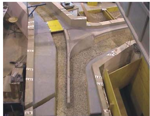
Variante Trennwand, Mündungsbereich Blick nach flussauf
