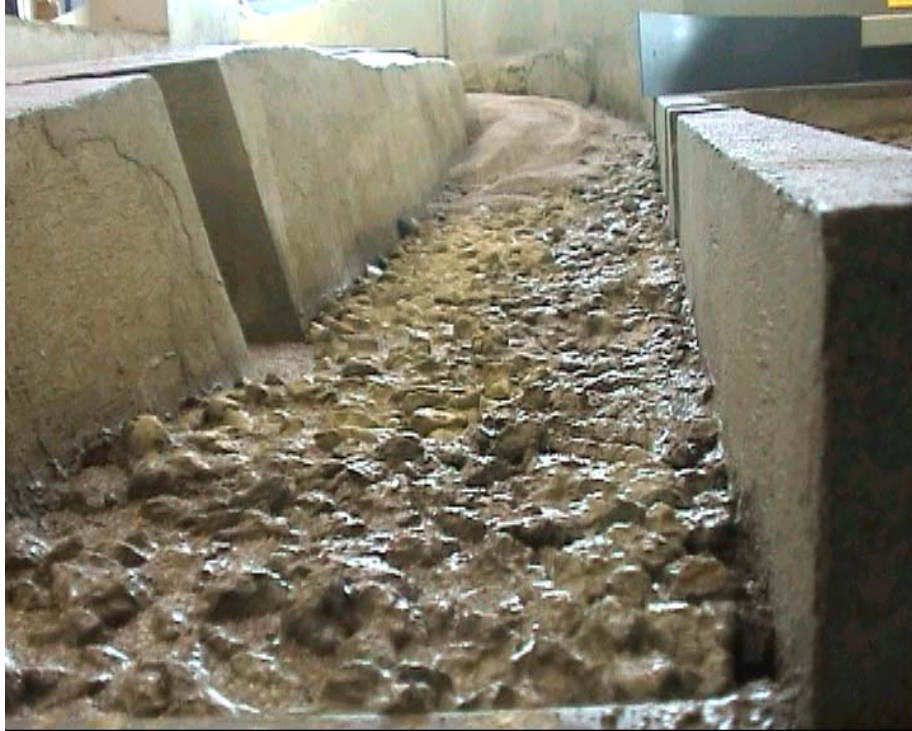
Abb. 54: Ablagerung beim Versuch V.2.G.1, Blick vom Absturz nach flussauf
