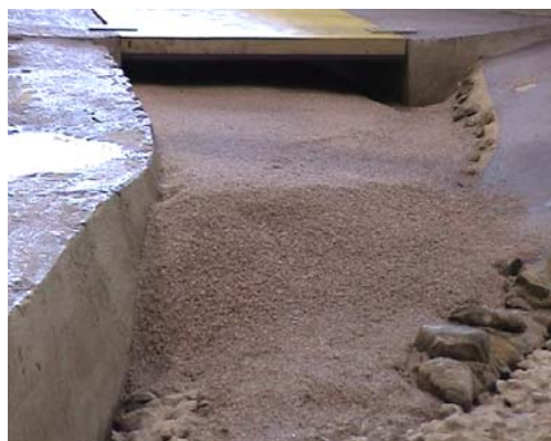
Abb. 35: Anlandung beim Versuch V.0.G.2.3; Blick vom Mündungsbereich nach flussauf
