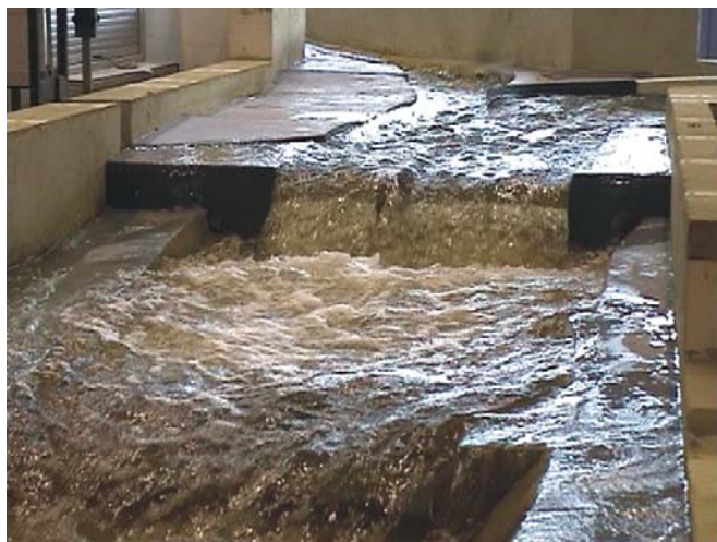
Variante 2: Abgesenkte Trennwand
