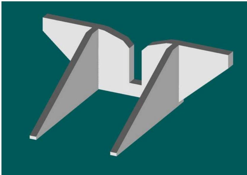
Abbildung 56: Kronenoffene Offene Schlitzsperre mit einem senkrechten Schlitz
