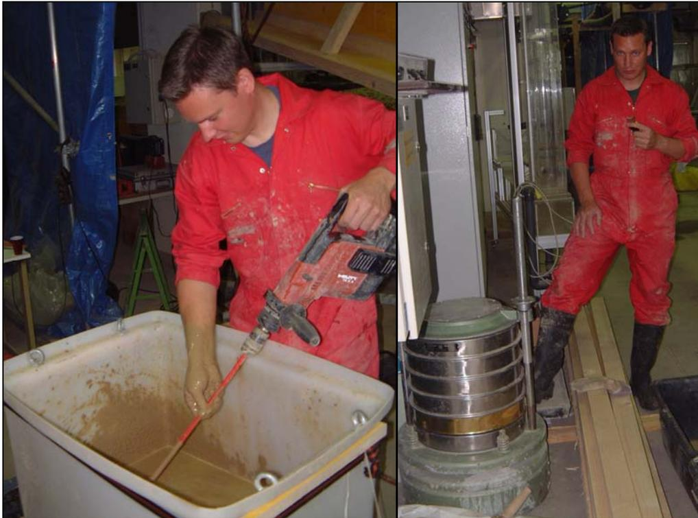
Abbildung 13: Mischen des Versuchsmaterials und Siebung des Grobsediments
