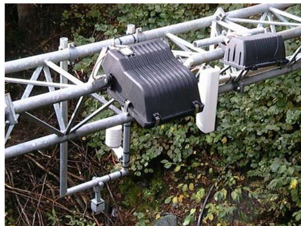
Foto 3: Kamera 2 mit Scheinwerfer, Ultraschall und Temperaturmessgerät
