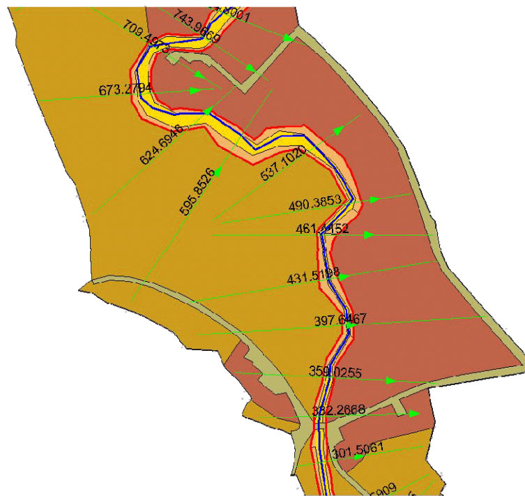
Abbildung 25: Ausschnitt (Grub) aus dem Polygonthema mit verschiedenen Rauigkeiten und den für Hec Ras gesetzten Querprofilen.
