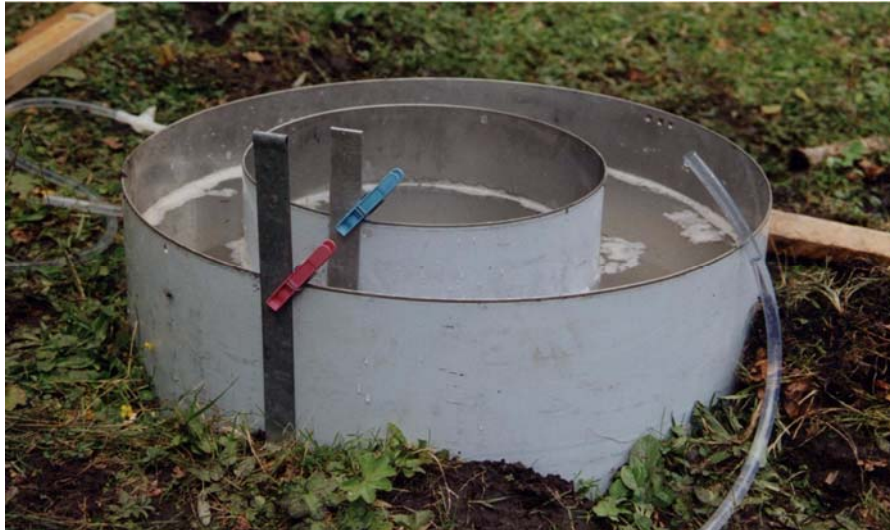
Foto 1: Doppelringinfiltrometer Messstelle D A1-1M Infiltrationsversuch V ID
