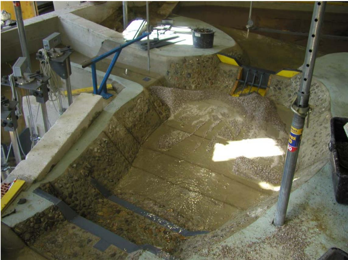
Abbildung 20: Aufnahme der Geschiebeablagerung nach simulierter Hochwasserwelle
