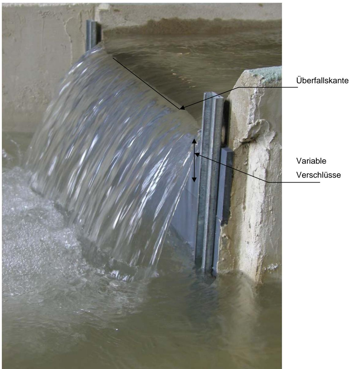
Abbildung 14: Rückgestauter Abfluss durch verschieden hohe Rechteckverschlüsse
