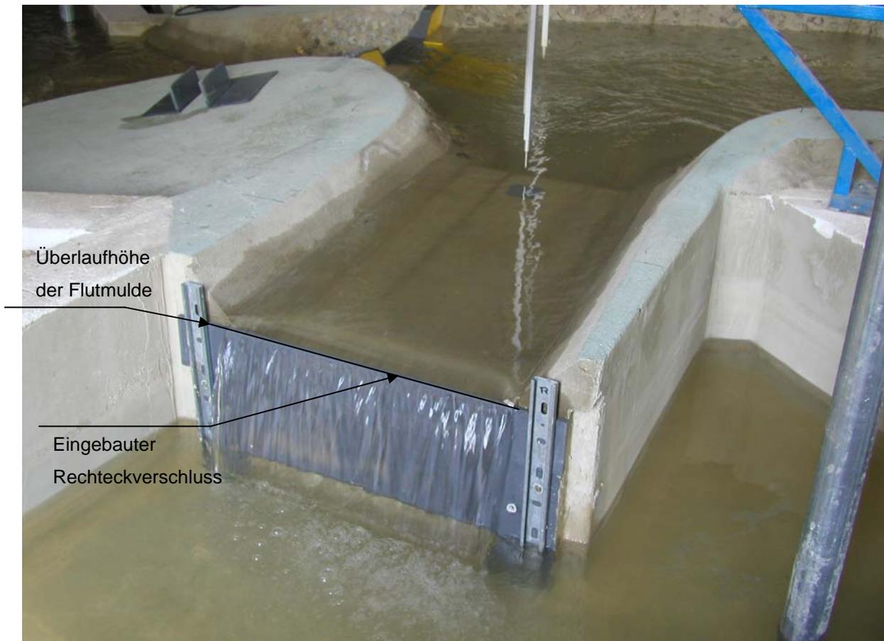
Abbildung 13: Rückgestauter Abfluss durch einen Rechteckverschluss in der Mulde
