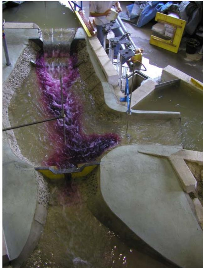
Abbildung 18: Zugabe des Färbemittels
