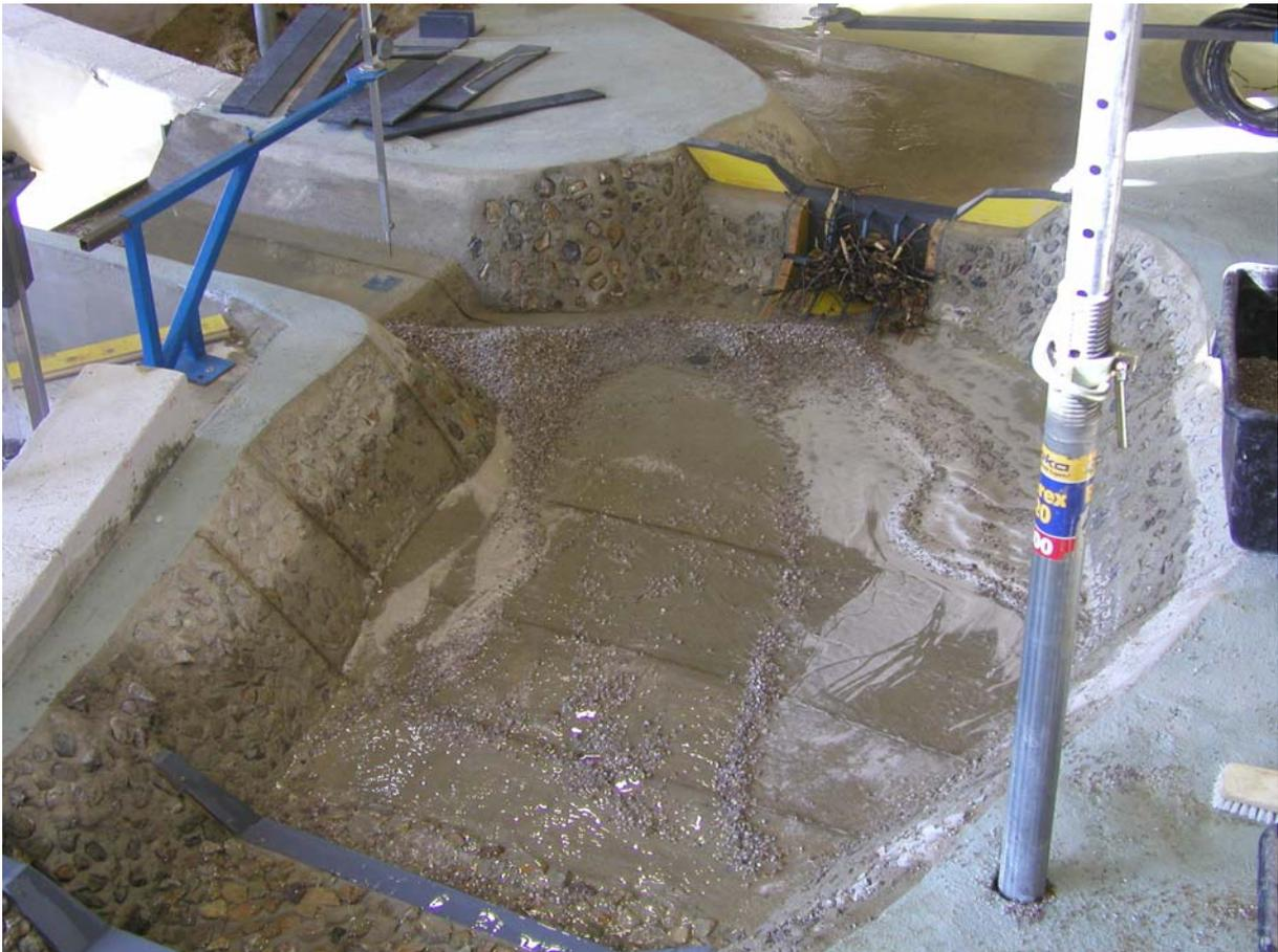
Abbildung 22: Geschiebeanlagerung mit verlegter Öffnung mit Holz
