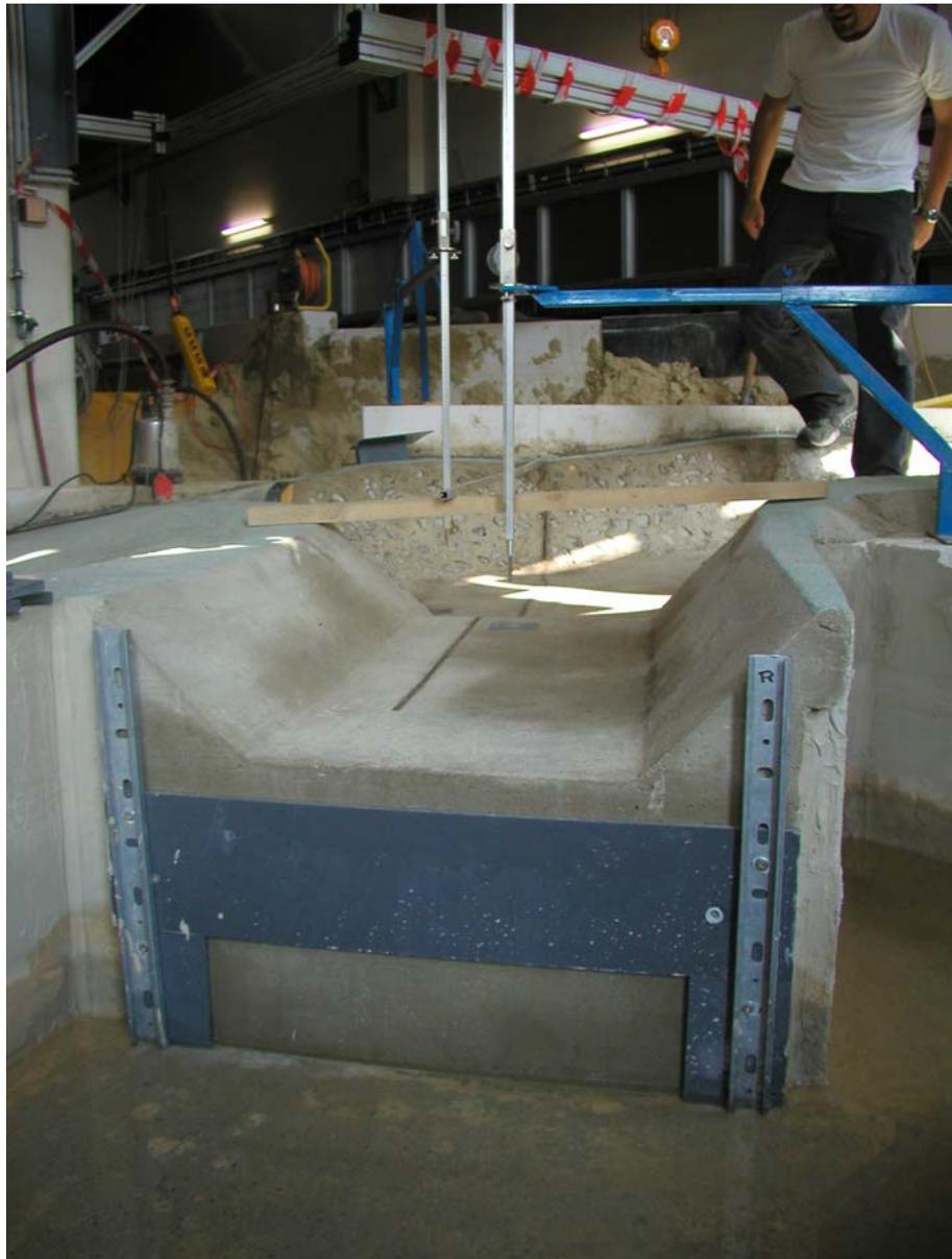
Abbildung 12: Freier Abfluss in der Flutmulde ohne Rückstau
