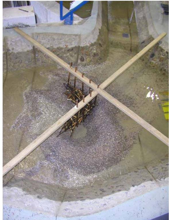
Abbildung 24: Geschiebeablagerung mit zusätzlichem Bauwerk
