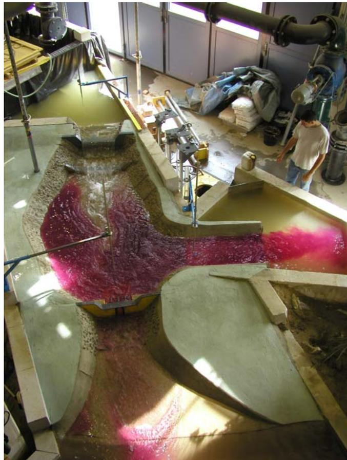
Abbildung 15: Versuchsanordnung „d“ mit rückgestautem Beruhigungsbecken.
