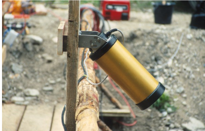
Abbildung 2: Seitenansicht des Radarsensors „KALESTO“, montiert am Messsteg.
