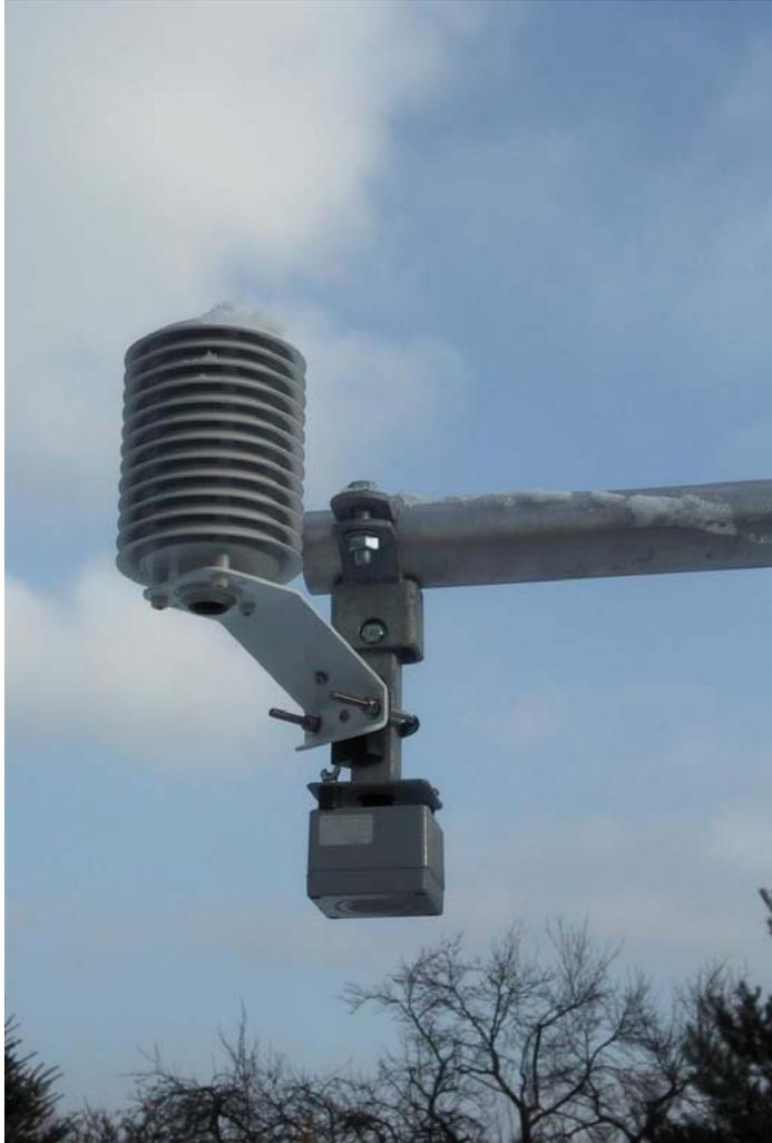
**Abbildung 8: Ultraschallsensor zur Ermittlung der Abflusstiefe**
