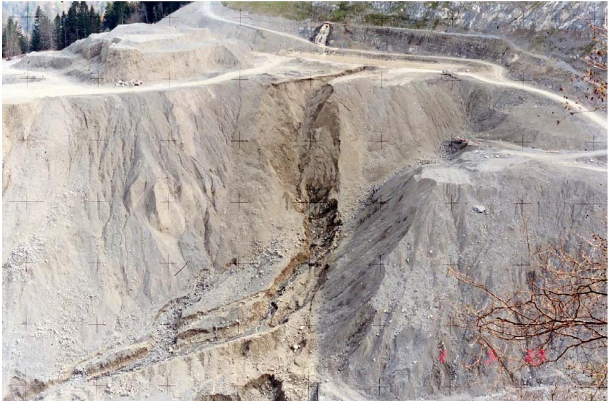
**Abbildung 12: Fotografie mit der Messbildkamera nach dem Murversuch**
