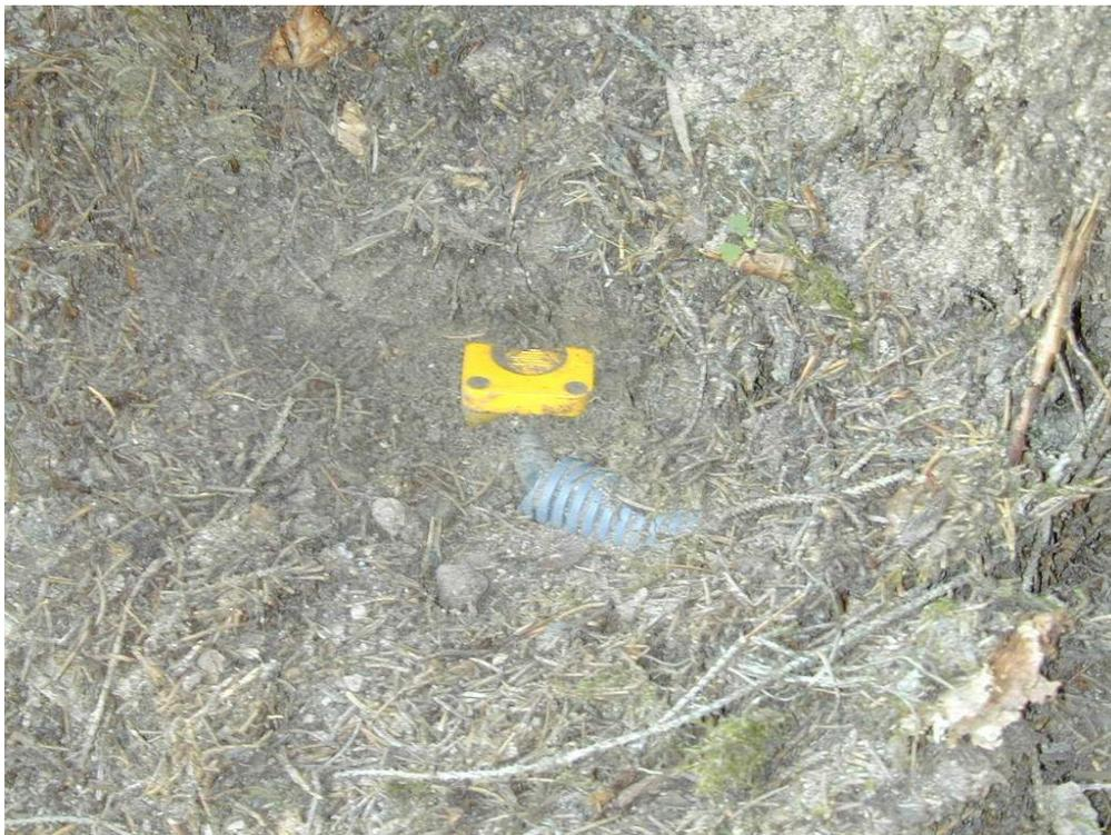
**Abbildung 9: Geophon in das Erdreich eingegraben**
