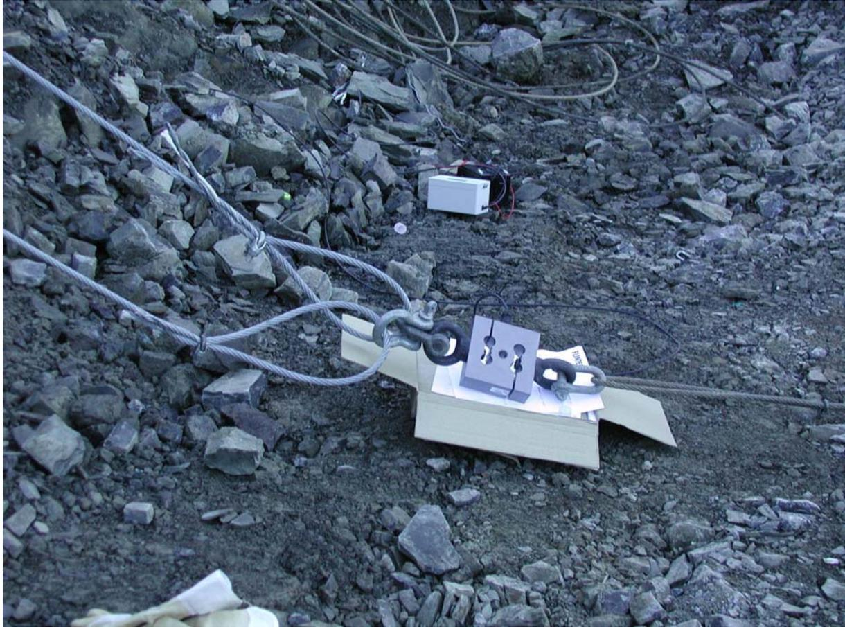
Abbildung 10: Einhängen der DMS-Wägezelle zwischen die Stahlseile
