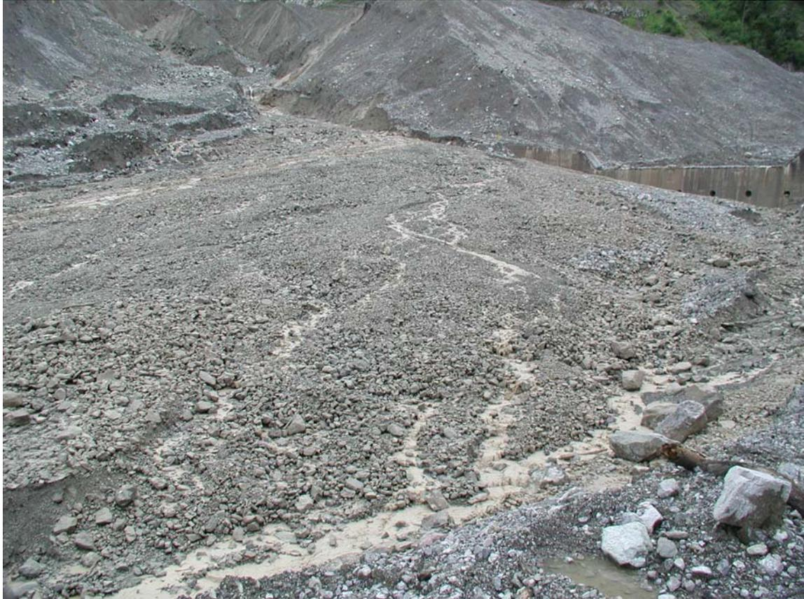
**Abbildung 40: Typische Ausbildung eines Murkegels beim dritten Versuch**
