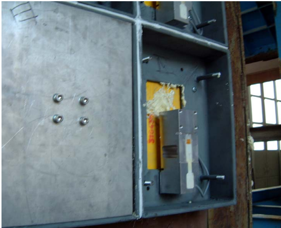
Abbildung 6: Montierte Druckzellen auf der Messstation. Rechts der Drucksensor in der Zelle noch ohne und links schon mit angeschraubter Druckplatte.
