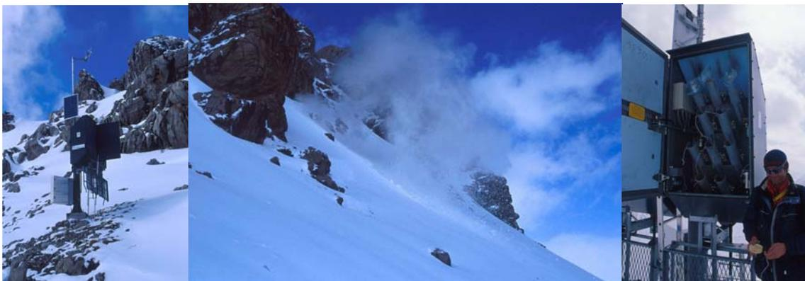
*Abbildung 36: links: funkferngesteuerte Lawinenorgel in Lech im Einsatz, (KREU, 2001); mitte: Sprengung durch Lawinenorgel in Lech, (KREU, 2001); rechts: Wiederbefüllung durch fachpersonal, Lech, KREU, 2001*
