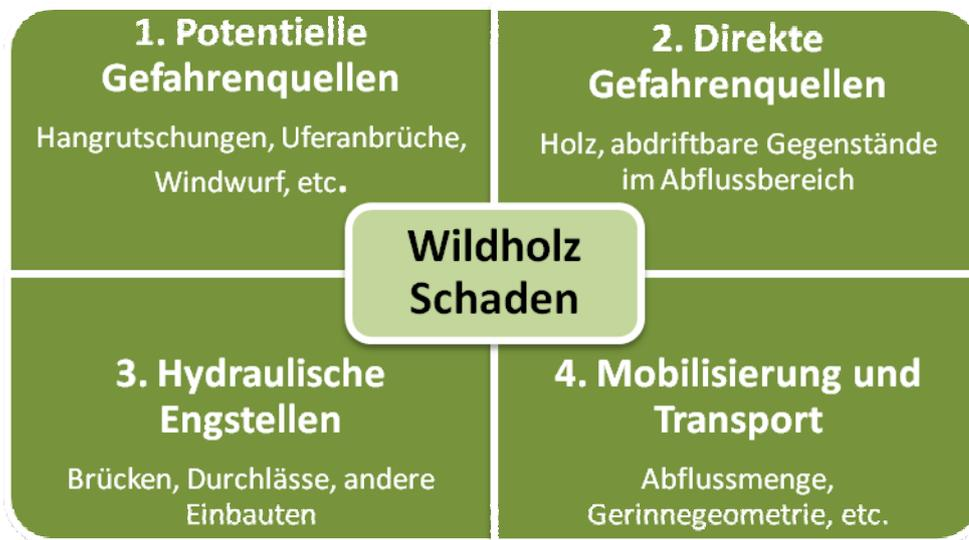
Abbildung 4: Wildholzschäden können durch ein Zusammenwirken von vier verschiedenen Faktoren entstehen
