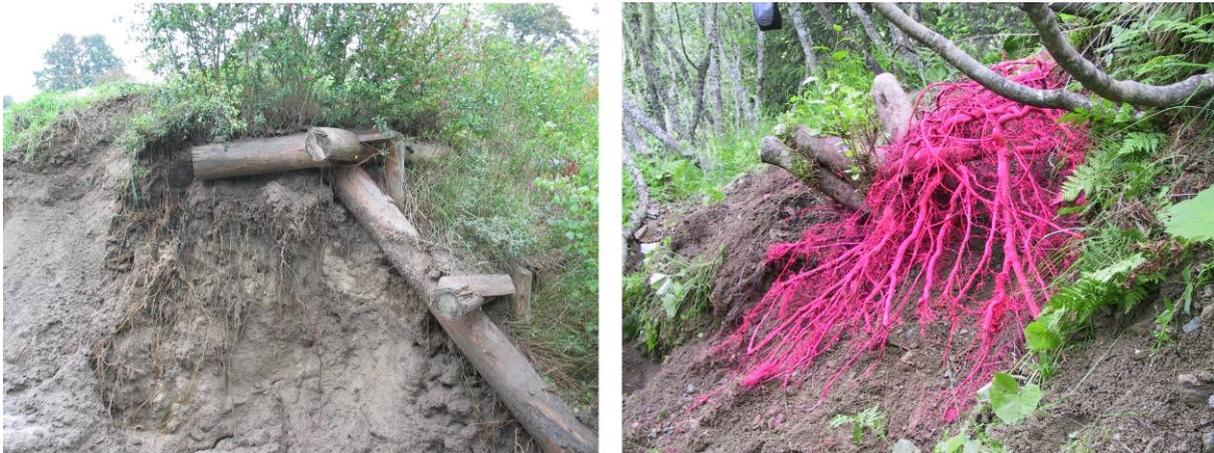
Abbildung 22: Wurzel ausgrabungen an ingenieurb biologischen Bauweisen (FOTO: Stangl R.)
