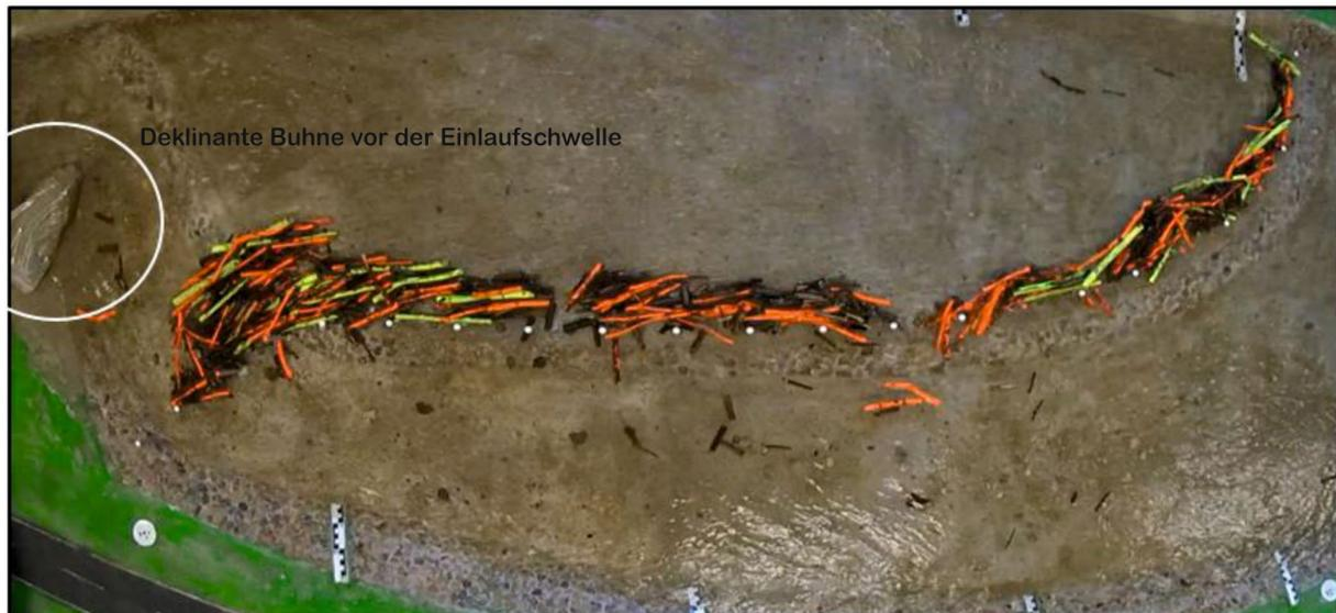
Abbildung 44: Modellversuch mit deklinanter Buhne kurz vor dem Einlaufbereich in den Nebenschluss (In Anlehnung an Hödl, 2021)
