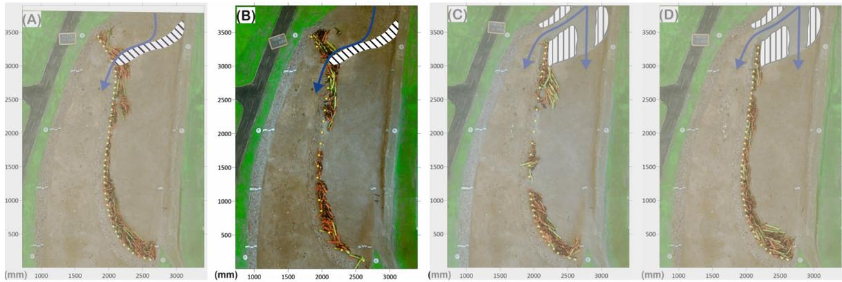
Abbildung 38: Orthofoto der Versuchsreihe V2 mit Überlaufschwelle und lichtem Abstand von 4,50 m
