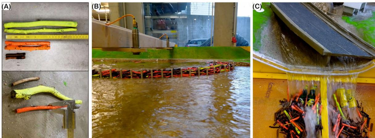
Abbildung 26: A: Beispiele der drei verwendeten Holzsortimente; B: Veranschaulichung der Ablagerung durch die unterschiedliche Färbung der Sortimente; C: Sortierung im Rücklaufbecken
