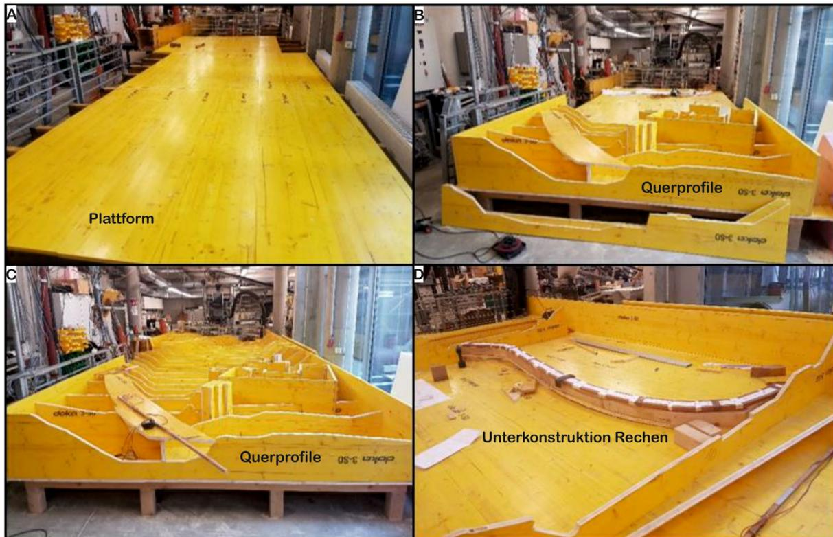
Abbildung 16: Grundgerüst des Modelles mit Plattform, Querprofilen und der Unterkonstruktion für den Rechen (In Anlehnung an Hödl, 2021)
