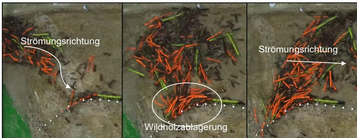
Abbildung 36: Wildholzablagerung der Versuchsreihe 1 bei Versuch HQ100.V.1.W.P.2 im Knickbereich des Wildholzrechens beim Übergang vom Hauptschluss zum Nebenschluss, in dem sich die Überlaufschwelle befindet, bei Versuchsreihe 1 bei Versuch HQ100.V.1.W.P.2 (Quelle: Hödl, 2021)
