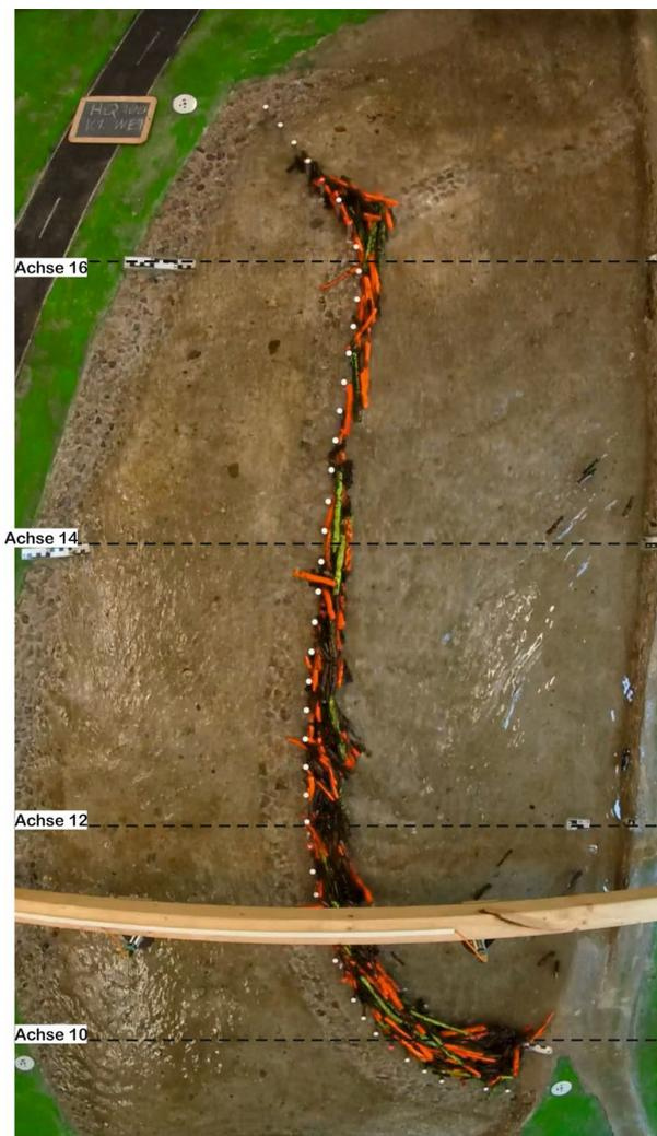
Abbildung 57: Wildholzablagerung im Versuch HQ100 V.1.W.E.1. zur Analyse der Wasserspiegelhöhen
