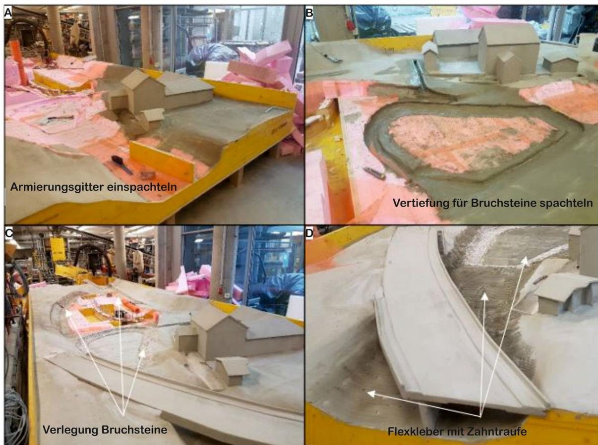
Abbildung 19: Abdichtung des Gerinnes mittels Flexkleber und Armierung (In Anlehnung an Hödl, 2021)
