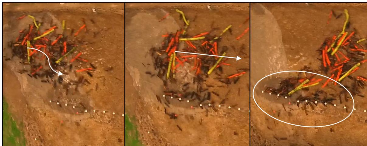
Abbildung 50: Wildholzablagerung der Versuchsreihe VO1 bei Versuch HQ100.V.O.1.W.P.1 in dem in Versuchsreihe 1 und 2 erwähnten Problembereich (In Anlehnung an Hödl, 2021)
