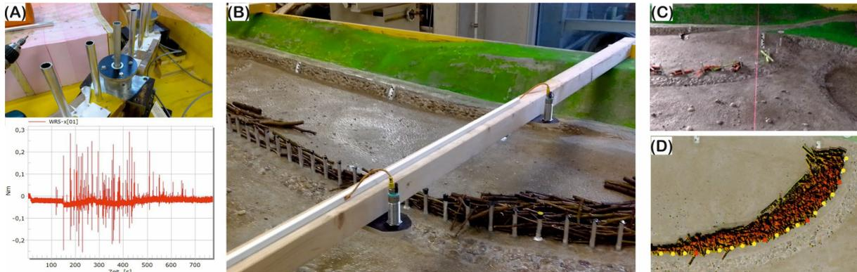
Abbildung 23: Messeinrichtungen im Modell. A) Dehnmessstreifen zur Momentenmessung; B) Ultraschall für Wasserspiegellagen; C) Laserscanner; D) Aus dem Laserscan erstelltes Höhenmodell der Ablagerung
