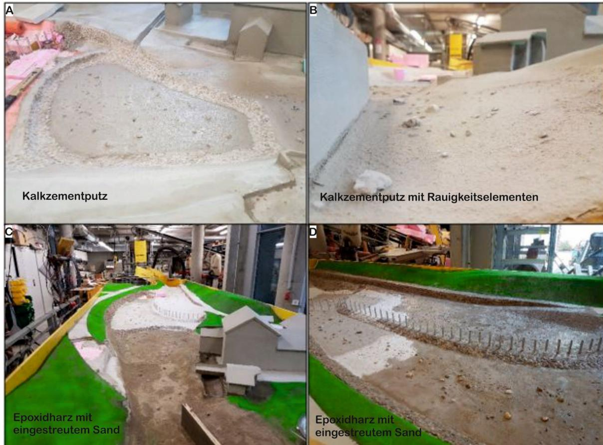
Abbildung 20: Verputzen und grobe Rauigkeitselemente im Gerinnebereich (A und B), Epoxidharz zum Abdichten und zur Einbringung der feinen Rauigkeitselemente (Sand) (C und D) (In Anlehnung an Hödl, 2021)
